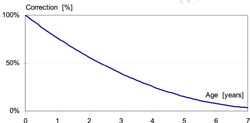
Figur 10. Ålderskorrektur för porösa vägytor, angiven som procent av vägytans ursprungliga dB-värde. Gäller för vägar där dubbdäck inte tillåts. Från [16].
