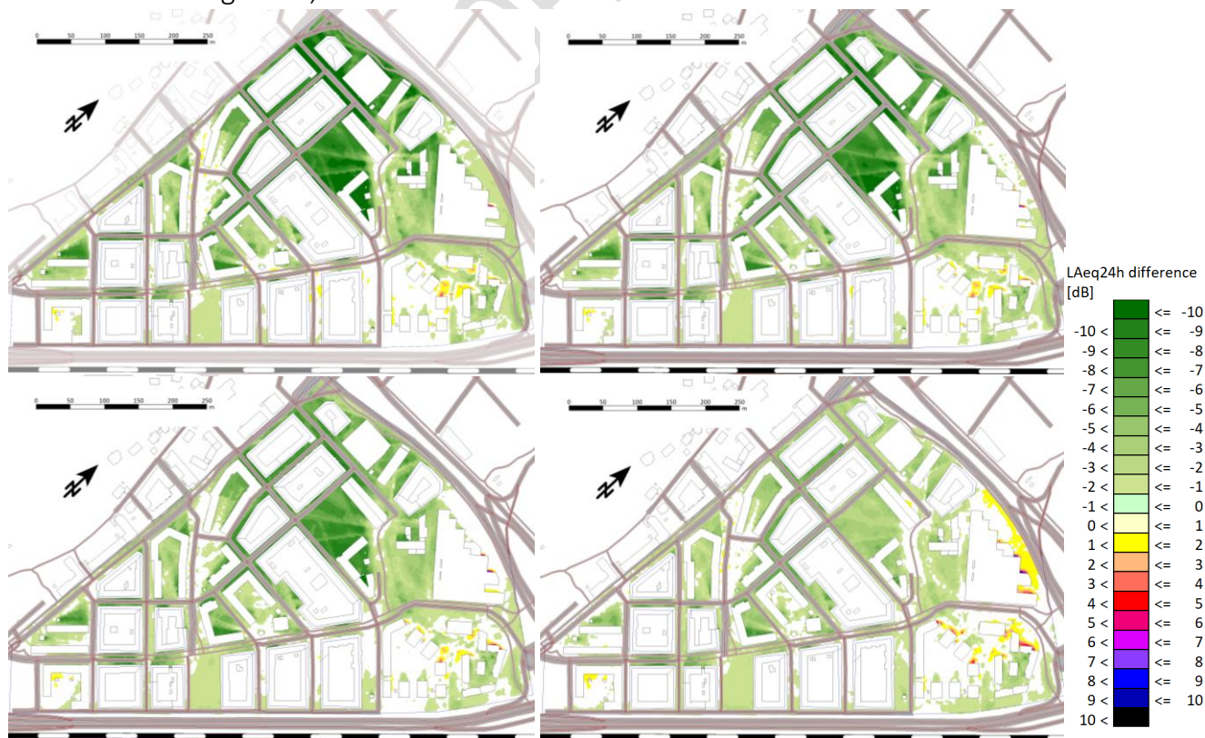
Figur 26. Brämaregården, skillnadsplottar ( L_{Aeq24h} ) Nord2000 – Nord96, beräkningshöjd = 2 m. Vindhastigheter: övre vänster 1 m/s, övre höger 1,5 m/s, nedre vänster 2 m/s och nedre höger 3 m/s.
