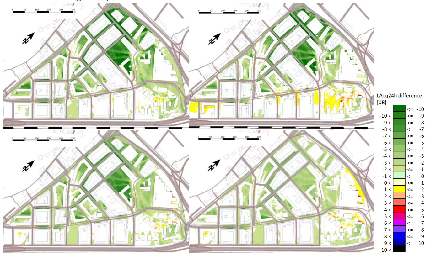
Figur 29. Brämaregården, skillnadsplottar ( L_{A_{fmax}} ) Nord2000 – Nord96, beräkningshöjd = 2 m. Vindhastigheter: övre vänster 1 m/s, övre höger 1,5 m/s, nedre vänster 2 m/s och nedre höger 3 m/s.
