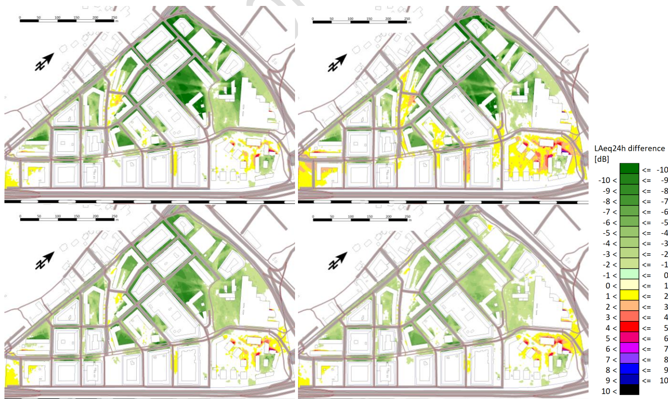
Figur 30. Brämaregården, skillnadsplottar ( L_{A_{fmax}} ) Nord2000 – Nord96, beräkningshöjd = 5 m. Vindhastigheter: övre vänster 1 m/s, övre höger 1,5 m/s, nedre vänster 2 m/s och nedre höger 3 m/s.
