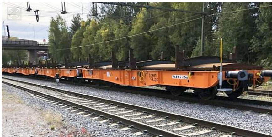
Foto 6: Denna moderna typ av godsvagn för transport av slabs har littera Sgmmns och är försedd med skivbromsar
