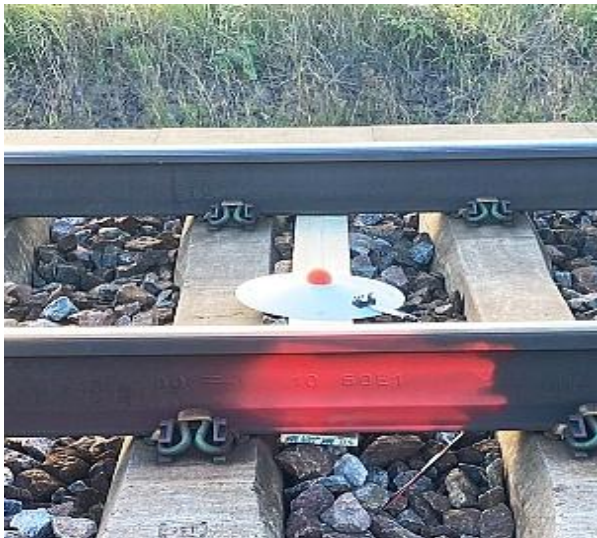
Foto 1: Mikrofonplatta placerad på ballasten mellan rälen
